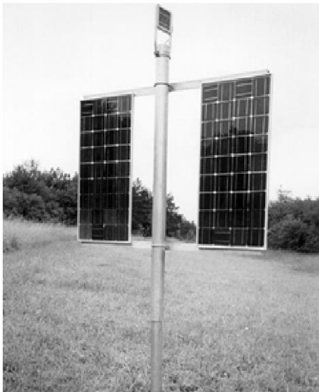
Şekil 12. Tasarlanan harici iki taraflı FV tabanlı GTS
