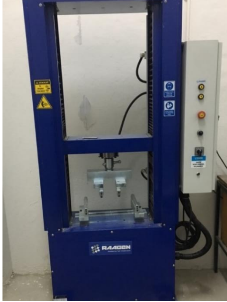
Şekil 2. 50 KN kapasiteli deplasman kontrollü pres.
