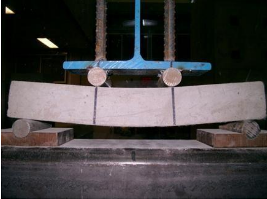
Şekil 1. ECC'nin eğilme yükleri altındaki davranışı
