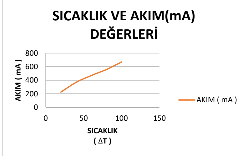
Şekil 2. Termoelektrik jeneratöründen elde edilen akımın sıcaklık ile değişimi
