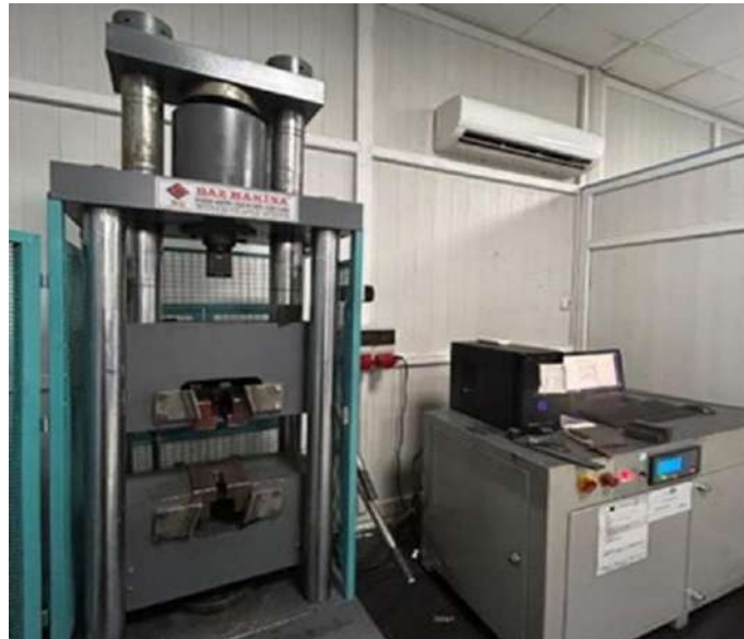
Şekil 8. Baz Makine marka 100 kN kapasiteli basma cihazı
