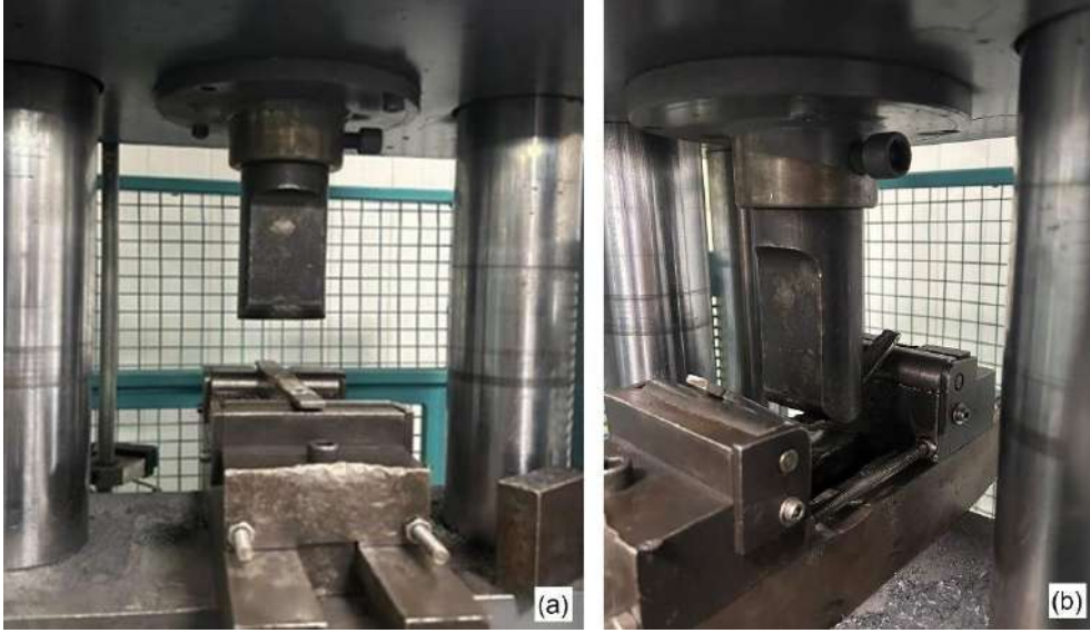
Şekil 9. Üç nokta eğme testleri: a) Standart eğme numunesi ve eğme aparatı ve b) Üç nokta eğme testi anı
