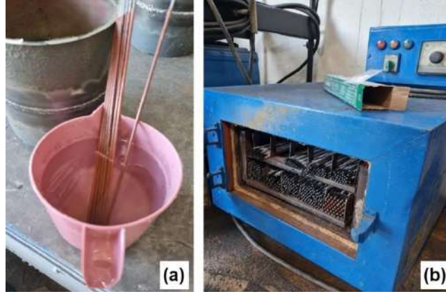
Şekil 2. Elektrot şartlandırması: a) elektrot nemlendirme-kirletme ve b) TİT marka elektrot ısıtma fırınında kurutma [57, 58]
