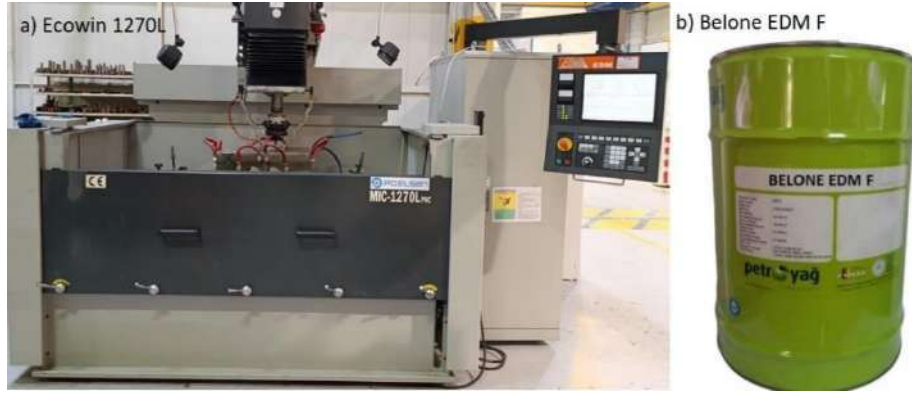
Şekil 4. DEİ prosesine ait işleme görünümü a) Ecwin 1270L tezgâhı uzak görünüm b) Dielektrik sıvı
