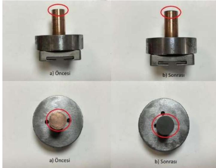
Şekil 3. Katot malzemesinin görünümü a) İşleme öncesi ve b) İşleme sonrası.
