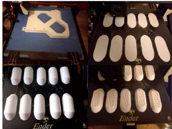
Şekil 4. 3B teknolojisi ile gövde üretimi
