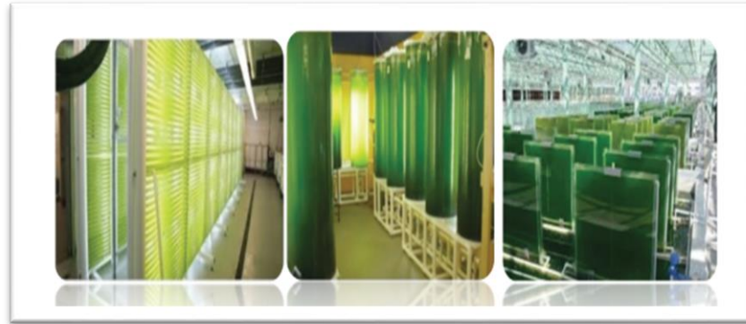
Görsel 2.3. Yatay tübüler, sarmal tübüler, düz-plaka fotobiyoreaktörler (Oktor, 2018)
