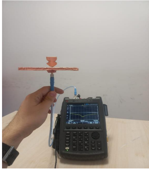
Şekil 14: Üretilen Antenin Ölçümü
