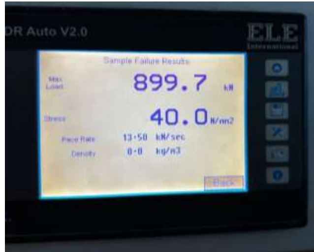
B: Basınç dayanımı ölçüm ekranı
