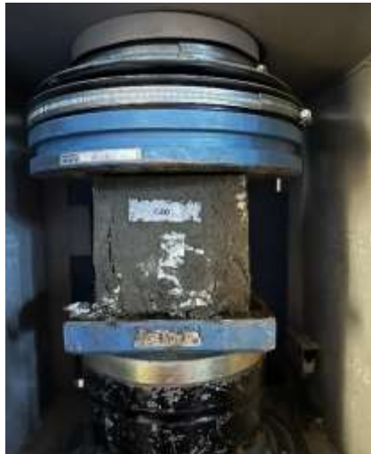
A: Numunenin pres makinesine yerleştirilmesi
