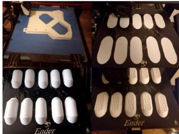
Şekil 4. 3B teknolojisi ile gövde üretimi
