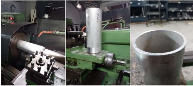
Şekil 5. Alüminyum boru yüzey temizleme işlemi
