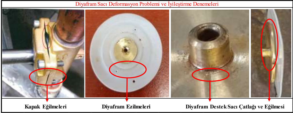
Şekil 4. Hidrostatik Patlatma Sonucu Meydana Gelen Hasarlar
