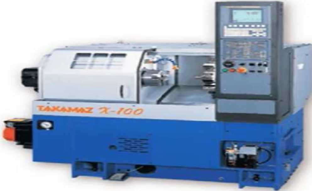
Őekil 6: Takamaz X100 CNC Torna Tezgâhı
