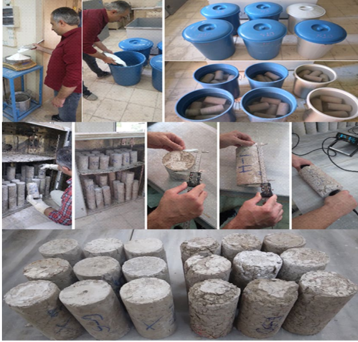
Şekil 3. Numunelerin %5 ve %10 Na 2 SO 4 çözeltisine maruz bırakılması ve her 5 döngü sonunda ölçümlerin alınması
