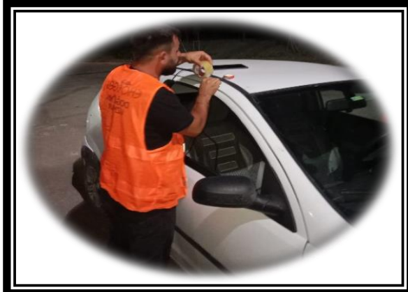
Fotoğraf 2. Sürüş transekti için echometer pro dedektörün araba dışına bağlanması
