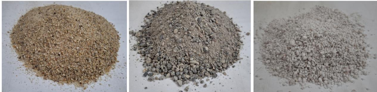
Şekil 1. Standart kum-geri kazanılmış agrega-genleştirilmiş perlit agregası
