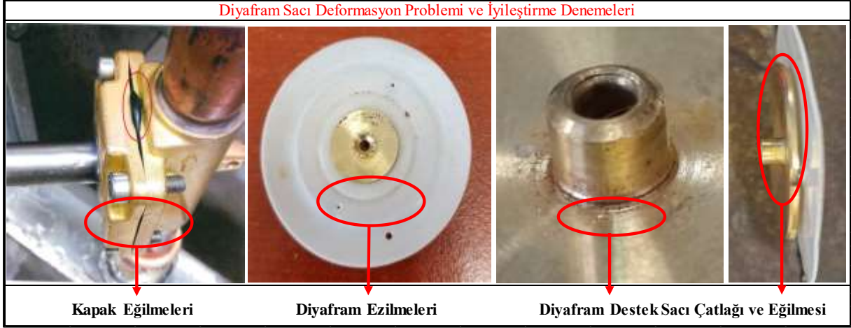
Şekil 4. Hidrostatik Patlatma Sonucu Meydana Gelen Hasarlar
