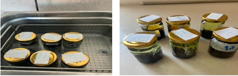
Resim 3. Ultrasonik banyoda ekstraksiyon
