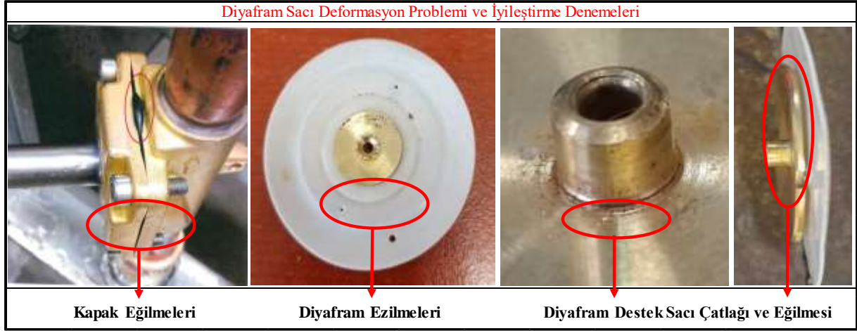
Şekil 4. Hidrostatik Patlatma Sonucu Meydana Gelen Hasarlar
