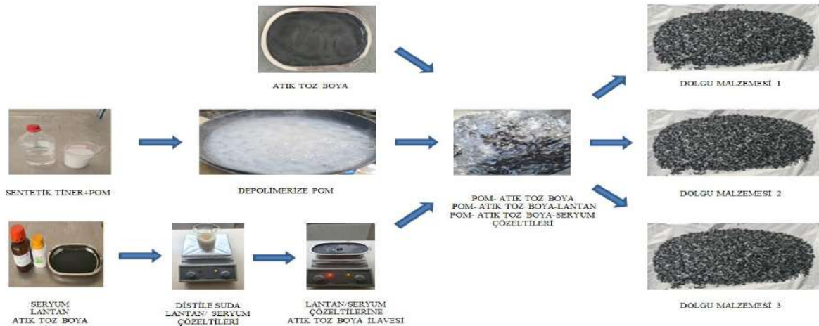
Şekil 1. Dolgu malzemelerinin hazırlanması işlemi şematik gösterimi
